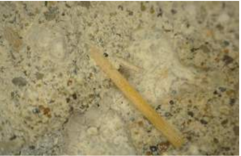
FIG. 4: Immagine al microscopio digitale (50x) dell'intonaco di arriccio
