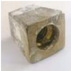
FIG. 16: Pernio metallico trovato all’interno della parete settentrionale durante i restauri
