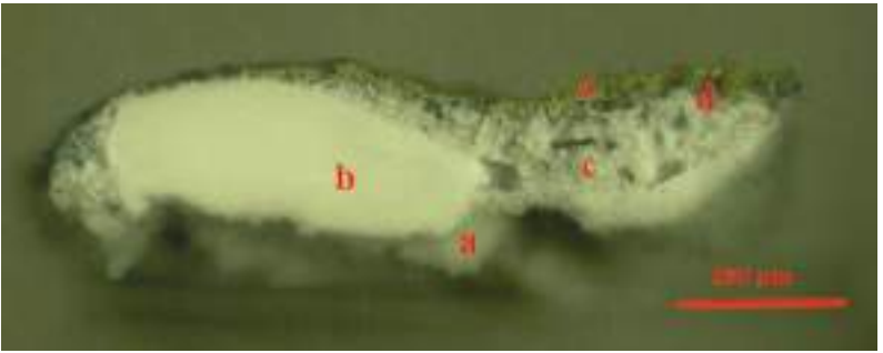
FIG. 4: Tracce di intonaco di colore d’insieme biancastro (a); strato di preparazione di colore d’insieme bianco (b); strato pittorico di colore d’insieme grigio (c); strato pittorico di colore d’insieme azzurro-nerastro a struttura omogenea (d); strato pittorico di colore d’insieme giallo scuro a struttura omogenea (e)
